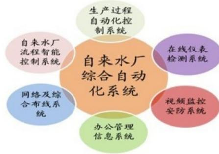
自来水厂自控系统工程一般采用集散型二级分布式计算机控制系统。由设在中央控制室的集中监控管理级计算机和厂区现场PLC控制站组成。中央控制室的集中监控管理计算机与厂区现场控制站PLC组成一个数据通信网络系统。各现场控制站PLC巡回检测各工段的工艺参数和电气参数，进行相应的处理，完成各自工段工艺设备的过程控制，并向中央控制室实时传送所需的信息。在中央控制室通过鼠标、键盘可控制现场主要设备的启动和停止。
