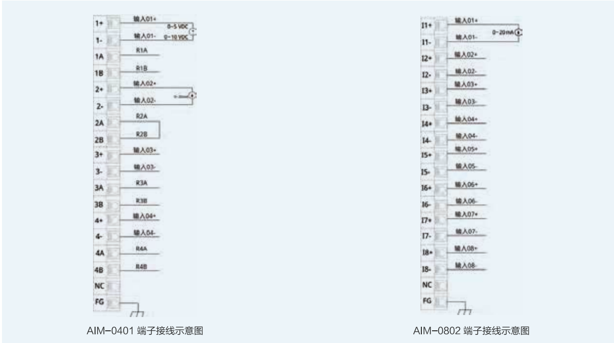
模拟量输入模块外部接线端子图
